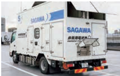
非常用電源車
