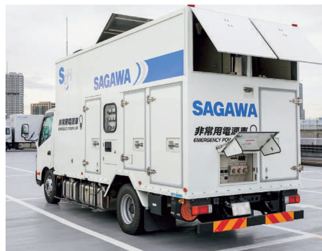
非常用電源車
