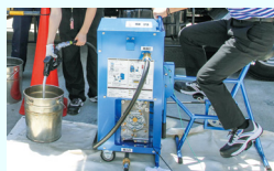
ペダルをこぐとノズルから燃料が出てきます
